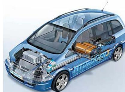
Figure 4 : Véhicule « HydroGen3 Compressed 700 » développé par General Motors [4].
